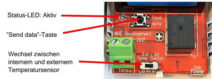
A) Entfernen Sie die Abdeckplatte und setzen die Batterien ein. Die Status-LED muss nun blinken. Der Raumtemperatursensor ist mit einem internen und einem externen Temperatursensor ausgestattet. Sorgen Sie immer dafür, dass der Raumtemperatursensor eingestellt ist, den internen Sensor zu nutzen. Dies tun Sie über den kleinen Schalter unten an der Steuerplatine, wo „Ext / Int“ geschrieben steht. Der Schalter muss auf „Int“ stehen.
