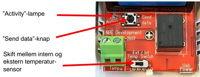
A) Tag det yderste skjold af rumtemperatursensoren og sæt batterier. Tjek nu, at "activity"-lampen blinker. Se billedet ovenfor. Rumtemperatursensoren er udstyret med en ekstern og en intern temperatursensor. Sørg altid for, at rumtemperatursensoren er indstillet til at bruge den interne sensor. Dette gøres på den lille knap nederst på printet, hvor der står "Ext / Int". Knappen skal stå på "Int".
