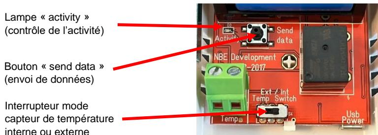
A) Enlevez le blindage externe du capteur de température ambiante et insérez les piles. Vérifiez si la lampe « activity » clignote (voir photo ci-dessus). Le capteur de température ambiante est équipé d'un capteur externe et interne. Assurez-vous que le capteur de température ambiante soit toujours réglé pour utiliser le capteur interne. Vous pouvez le choisir en bas de la carte mère, où vous pouvez basculer entre "Ext / Int". Le bouton doit toujours être sur « Int ».
